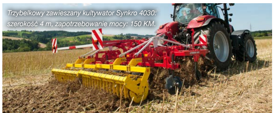
Czterometrowy kultywator wyposażony w 2 belki potrzebuje ciągnika o mocy 120 KM.
