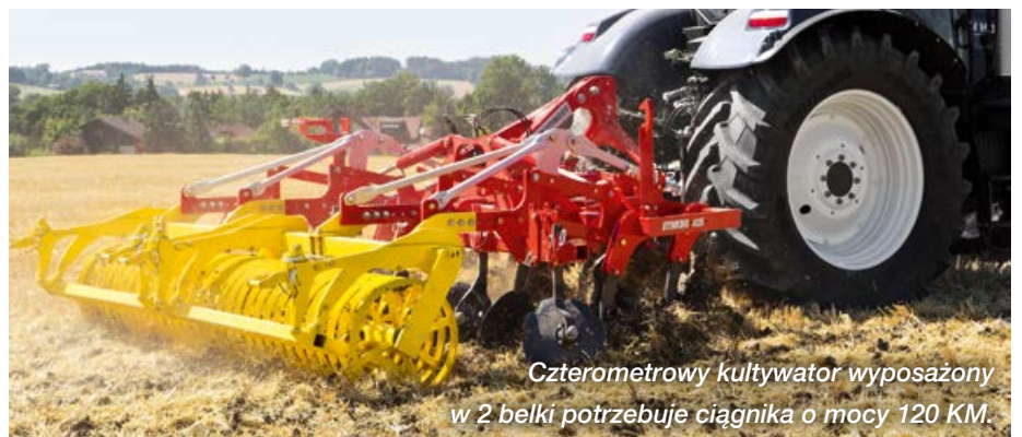
Trzybelkowy zawieszany kultywator Synkro 4030: szerokość 4 m, zapotrzebowanie mocy: 150 KM.
