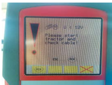
Zasilanie elektryczne powinno być podłączone bezpośrednio z akumulatora.
