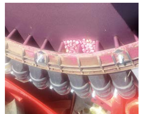
Sprawdzenie drożności przewodów nasennych jest szczególnie ważne w siewnikach nie wyposażonych w system kontroli wysiewu.
